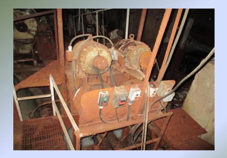
Pallet of motors (4) – HP 1)15,2)7.5,3)15,4)1.5 RPM 1)1750,2)1750,3)1740,4)1740 – V 1)575,2)550,3)230,4)550
